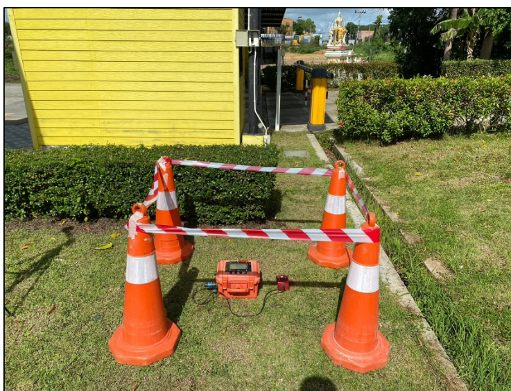
รูปที่ 4.3.3-2 แสดงการตรวจวัดความสั่นสะเทือน บริเวณบริษัท ลานทอง 2019 จำกัด
